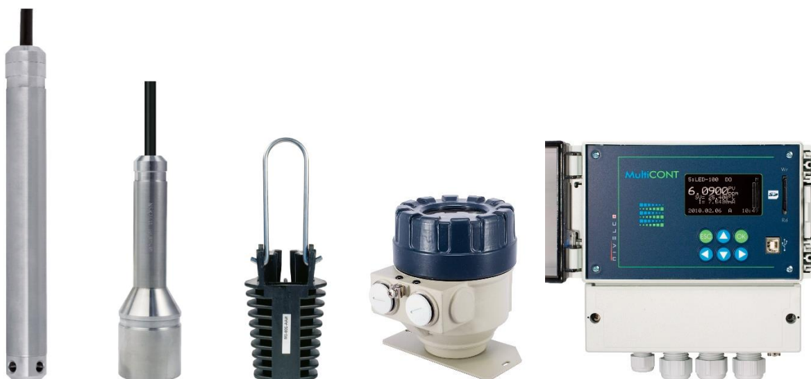
Obr. 35 – Provozní hydrostatické senzory hladiny s ponornou sondou NIVOPRESS N, postupně zleva doprava: tři typy ponorných sond, hlavice s převodníkem UniCONT a vyhodnocovací a vizualizační modul MultiCONT, zdroj (Nivelco Process Control, 2022a)
