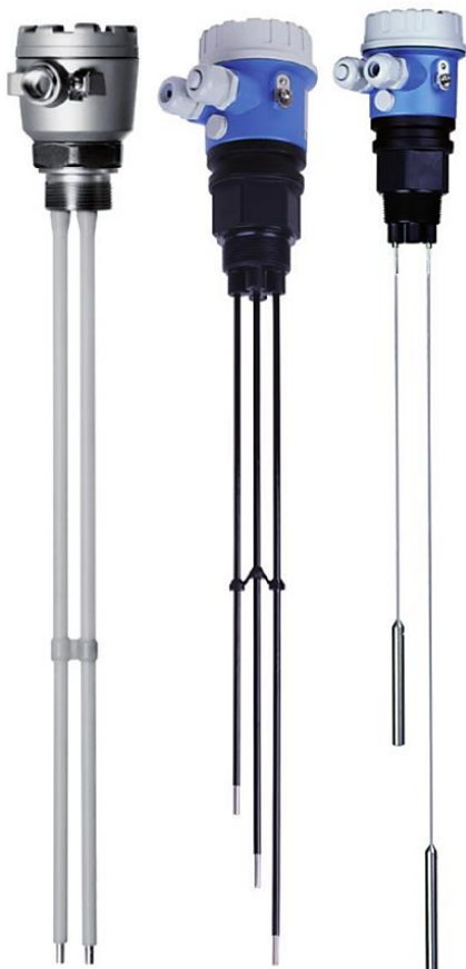
Obr. 39 – Vodivostní senzory a spínače hladiny Liquipoint FTW: dvouelektrodotový senzor se spojitým výstupem pro nevodivé provozní nádoby (vlevo), třielektrodotový spínač s tyčovými elektrodami (uprostřed) a dvou vodičový spínač s lanovými elektrodami (vpravo), zdroj (Endress+Hauser Czech, 2023a)
