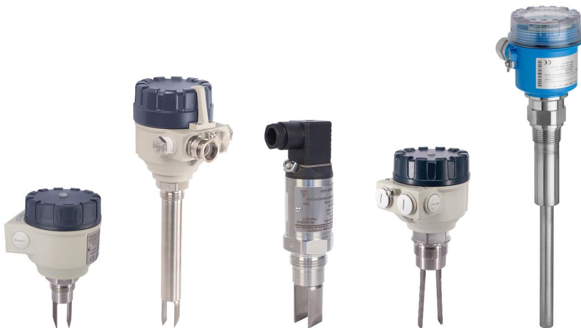
Obr. 22 – Různé typy provozních vibračních hladinoměrů NIVOSWITCH a Soliphant: pro kapaliny s krátkými vidličkami (první dva zleva), pro sypké látky s dlouhými vidličkami (třetí a čtvrtý zleva) a pro sypké látky s tyčí (zcela vpravo), zdroj (Nivelco Process Control, 2022b) a (Endress+Hauser Czech, 2023b)
