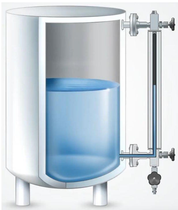
Obr. 3 – Princip obtokového stavoznaku, zdroj (D-Ex Instruments, 2022)
